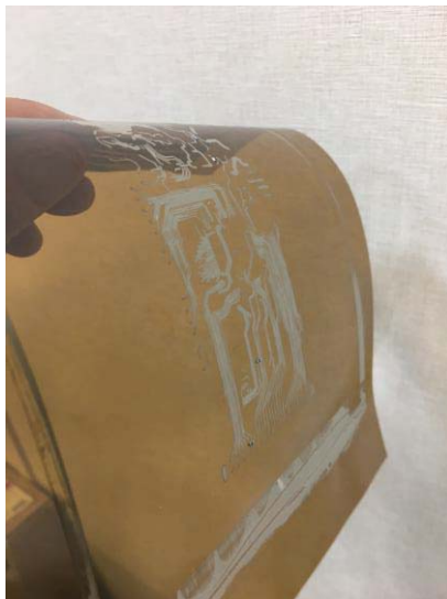
図 1 スクリーン印刷によって作製した銀微粒子電極の微細パターンニング。
